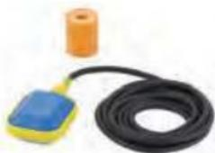
Поплавковый выключатель предназначен для управления включением/выключением насоса по уровню воды, поставляется в комплекте с грузиком, с помощью которого настраивается момент срабатывания контактной группы.
