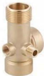
Пятивыводной штуцер применяется в автономных системах автоматического водоснабжения для соединения гидроаккумулятора, насоса, реле давления и манометра.
