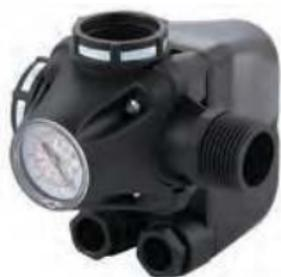
РМ/5-3W – реле давления со встроенным манометром и трехвыводным штуцером для управления однофазным насосом по настраиваемым порогам давления.
