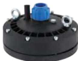
Оголовок скважинный предназначен для герметизации верхней части обсадной трубы скважины и присоединения к нему полиэтиленовой напорной трубы, электрокабеля, троса с подвешенным погружным скважинным насосом.
