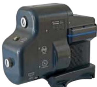
SCA MAX – это автоматическая насосная станция, состоящая из многоступенчатого насоса с энергоэффективным двигателем, частотного преобразователя, датчика давления и гидроаккумулятора, компактно соединённые внутри корпуса. Применяется для водоснабжения частных домов, повышения давления в системах водоснабжения, перекачивания воды из различных источников, а также для систем автополива.
