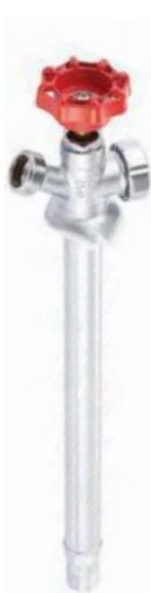
Незамерзающие краны серии WF предназначены для круглогодичного использования, в том числе и при отрицательных температурах окружающего воздуха. Запорная часть крана находится в пределах отапливаемого помещения, вентиль и излив — на улице, с внешней стороны здания. Остатки воды из наклонного носика вытекают сразу же после прекращения подачи воды под напором, в результате чего исчезает опасность возникновения ледяных пробок, способных препятствовать стоку воды.
