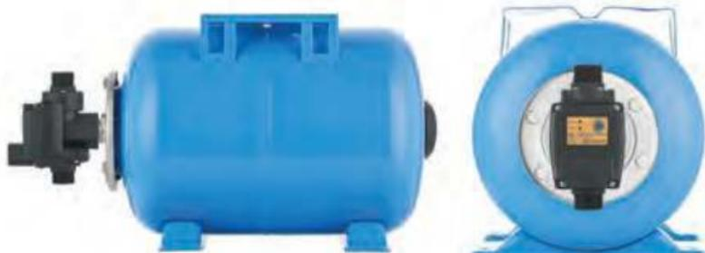
Комплект автоматики АКВАРОБОТ ТУРБИ-М3 с гидроаккумулятором 2 или 24 л предназначен для автоматического управления однофазными насосами мощностью до 1,5 кВт по потоку жидкости и двум порогам давления  $P_{\text{мин}}$  и  $P_{\text{макс}}$ .
