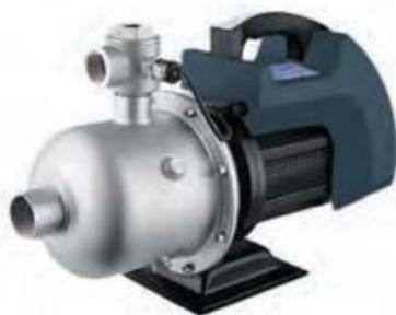
Насосы PSB – это много-ступенчатые центробежные насосы с энергоэффективным двигателем, встроенным частотным преобразователем и датчиком давления, предназначенные для водоснабжения с поддержанием постоянного давления. Насосы применяются в системах водоснабжения частных домов, коттеджей, промышленных и коммерческих объектов, а также для систем полива и ирригации.
