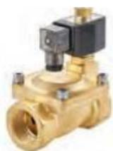
Электромагнитные клапаны устанавливаются на трубопроводах и в зависимости от исполнения (нормально закрытые или нормально открытые) открывают или перекрывают поток рабочей среды при поступлении на катушку (соленоид) клапана управляющего напряжения.
