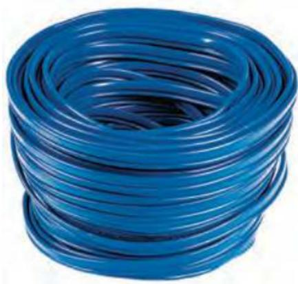
Кабели силовые серий *КВВ* и *КВВ-П* предназначены для подключения погружных насосов, длительно работающих в воде под давлением до 7,09 МПа (70 бар), к электрическим сетям на напряжение 450/750 В переменного тока частотой до 400 Гц.
