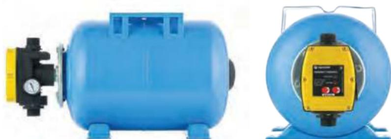
Комплект автоматики АКВАРОБОТ ТУРБИПРЕСС с гидроаккумулятором 24 л предназначен для автоматического управления однофазными насосами мощностью до 3 кВт по потоку жидкости и двум порогам давления  $R_{\text{мин}}$  и  $R_{\text{макс}}$ .
