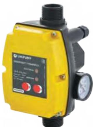
Блок АКВАРОБОТ ТУРБИПРЕСС с дополнительным выходом под гидроаккумулятор предназначен для автоматического управления однофазными насосами мощностью до 3 кВт по потоку жидкости и двум порогам давления  $R_{мин}$  и  $R_{макс}$ .
