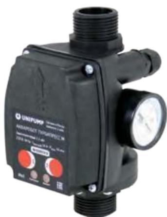
Блок АКВАРОБОТ ТУРБИПРЕСС М предназначен для автоматического управления однофазными насосами мощностью до 1,5 кВт по потоку жидкости и минимальному давлению  $R_{мин}$ .
