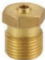
Клапан изготовлен из материалов не подверженных коррозии - латунь и нержавеющая сталь. Применяется для автоматического слива воды из трубопровода. Клапан открывает сливное отверстие при снижении давления в магистрали до 0,6–0,7 атм и закрывает отверстие при повышении давления до 1,5 атм.
