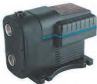
SCA MINI – это компактная автоматическая насосная станция, состоящая из многоступенчатого насоса с энергоэффективным двигателем, частотного преобразователя, датчика давления и гидроаккумулятор. Малые габариты станции позволяют легко установить её в условиях ограниченного пространства. Применяется для водоснабжения частных домов, повышения давления в системах водоснабжения, перекачивания воды из различных источников и полива дачных участков.
