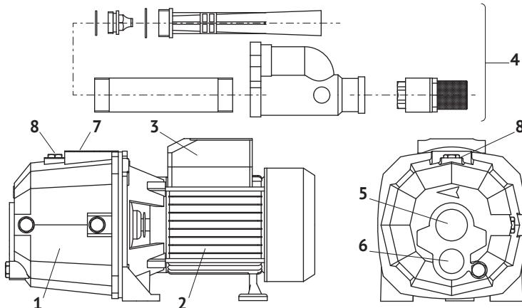
Насос состоит из следующих основных узлов: гидравлической части (1), электродвигателя (2), пускового устройства (3) и внешнего эжектора (4). В конструкцию внешнего эжектора входят следующие детали: корпус, трубка Вентури, сопло, патрубок, уплотнительные кольца, обратный клапан с сеткой. Корпус насоса имеет два отверстия входной магистрали 1¼" (5) и 1" (6), выходное отверстие 1" (7) и отверстие для первоначальной заливки воды (8).
