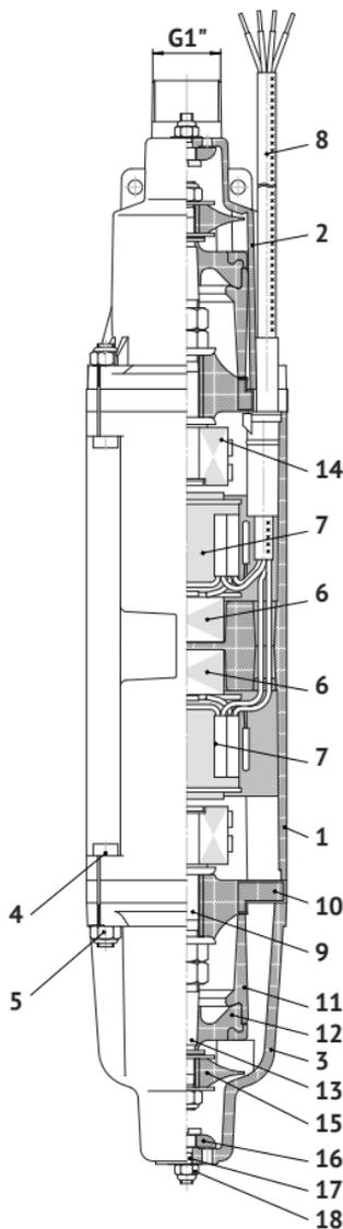
Подача воды осуществляется из напорных камер, ограниченных резиновыми клапаном и поршнем.
