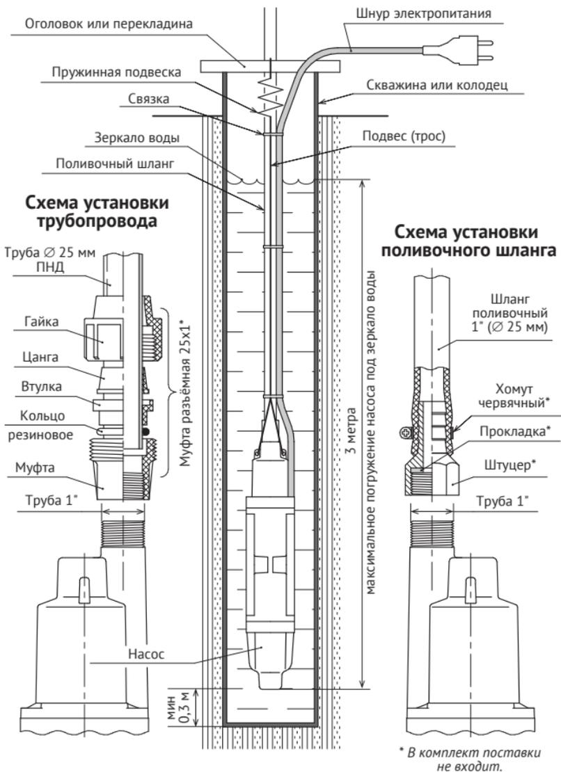
Рисунок 2 - Схема установки насоса в колодце или скважине
