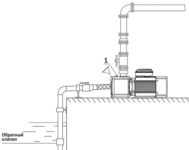
Рисунок 14 – Насос установлен выше уровня жидкости
