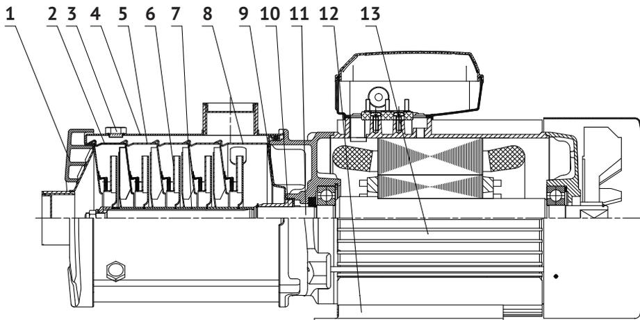
Рисунок 10 – Конструкция насоса
