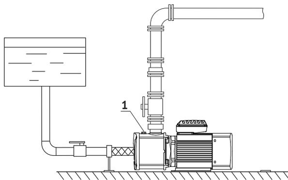
Рисунок 13 – Насос установлен ниже уровня жидкости
