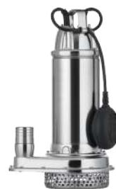
INOXPROF – одноступенчатый дренажный насос с корпусом и рабочим колесом из нержавеющей стали, оснащенный внешним поплавковым выключателем, для перекачивания чистой, загрязненной, хлорированной, морской воды и бытовых канализационных стоков с максимальным размером примесей и включений не более 6 мм.
