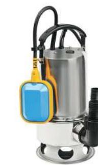
INOXVORT – одноступенчатый дренажный насос с внешним поплавковым выключателем для перекачивания чистой, хлорированной, слегка загрязненной воды с максимальным размером примесей и включений не более 35 мм\*.
