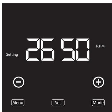
Рисунок 21 – Установка скорости в режиме самозапуска
