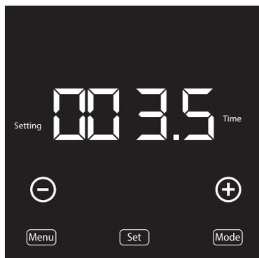
Рисунок 20 – Установка времени в режиме самозапуска
