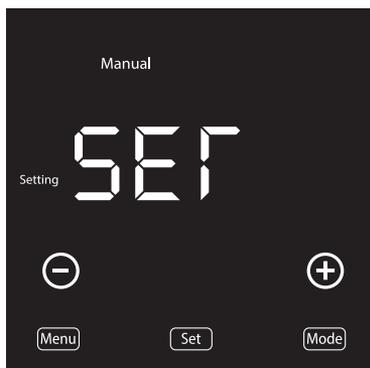
Рисунок 11 – Индикатор настройки в режиме «Ручной»
